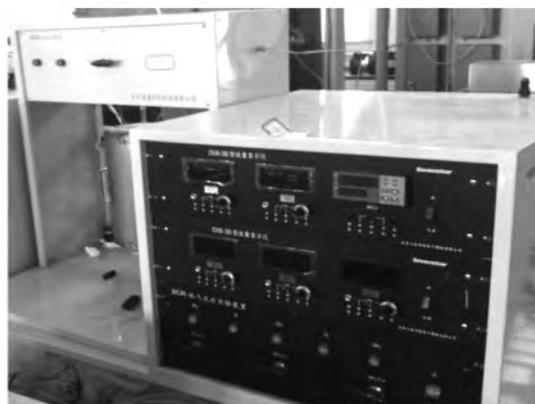
图2 实验系统中的温控、配气系统及反应炉实物图
